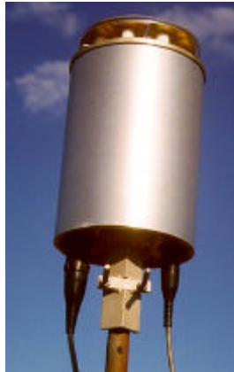
Fig. 3.1 - Electric Field Mill utilizado para monitoração do campo elétrico das nuvens de tempestade.
