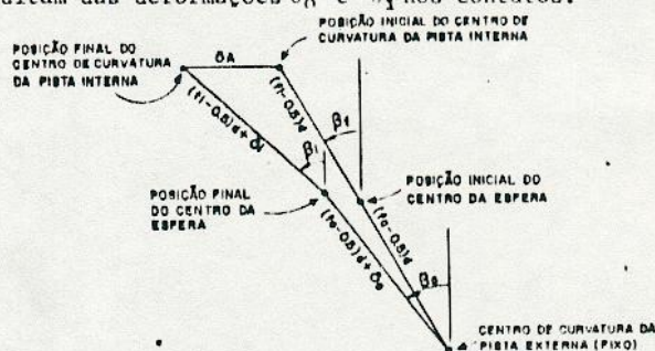
Figura 7. Pos. da esfera e dos centros de curvatura.
