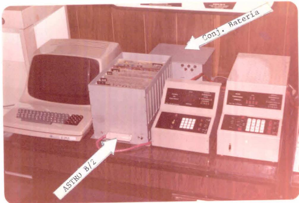
Fig. 2.2 - Fotografia do computador de bordo ASTRO B/2.
