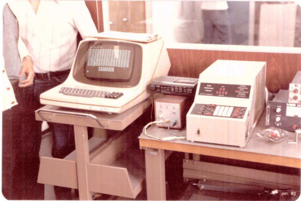
Fig. 2.7 - Fotografia da configuração da parte de computação do segmento solo.
