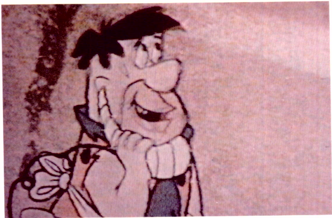
Fig. 9 - Imagem de TV obtida através do demodulador PLL, com a relação C/N de 4 dB.
