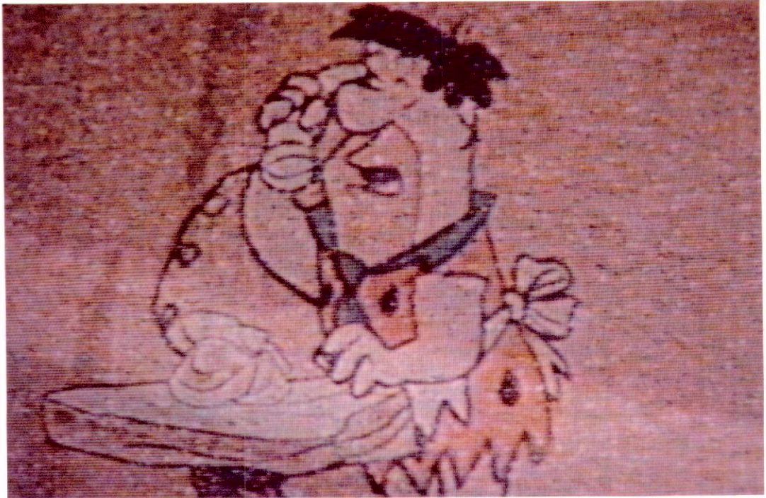
Fig. 18 - Imagem de TV obtida através de um demodulador sem extensão de limiar, com relação C/N de 5 dB.
