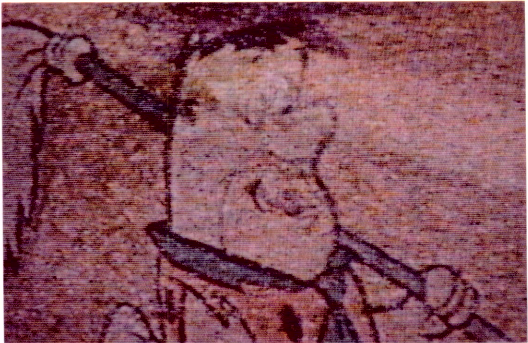
Fig. 19 - Imagem de TV obtida através de um demodulador sem extensão de limiar, com relação C/N de 4 dB.
