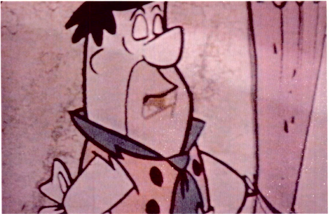
Fig. 6 - Imagem de TV obtida através do demodulador PLL, com a relação C/N de 7 dB.
