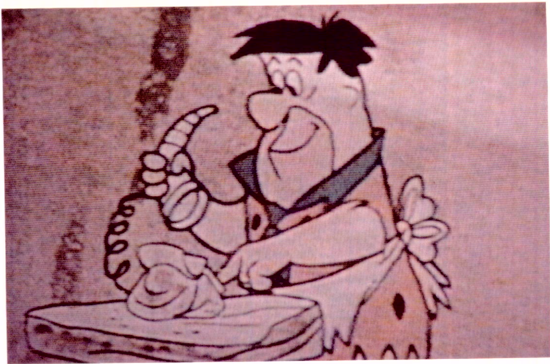
Fig. 8 - Imagem de TV obtida através do demodulador PLL, com a relação C/N de 5 dB.
