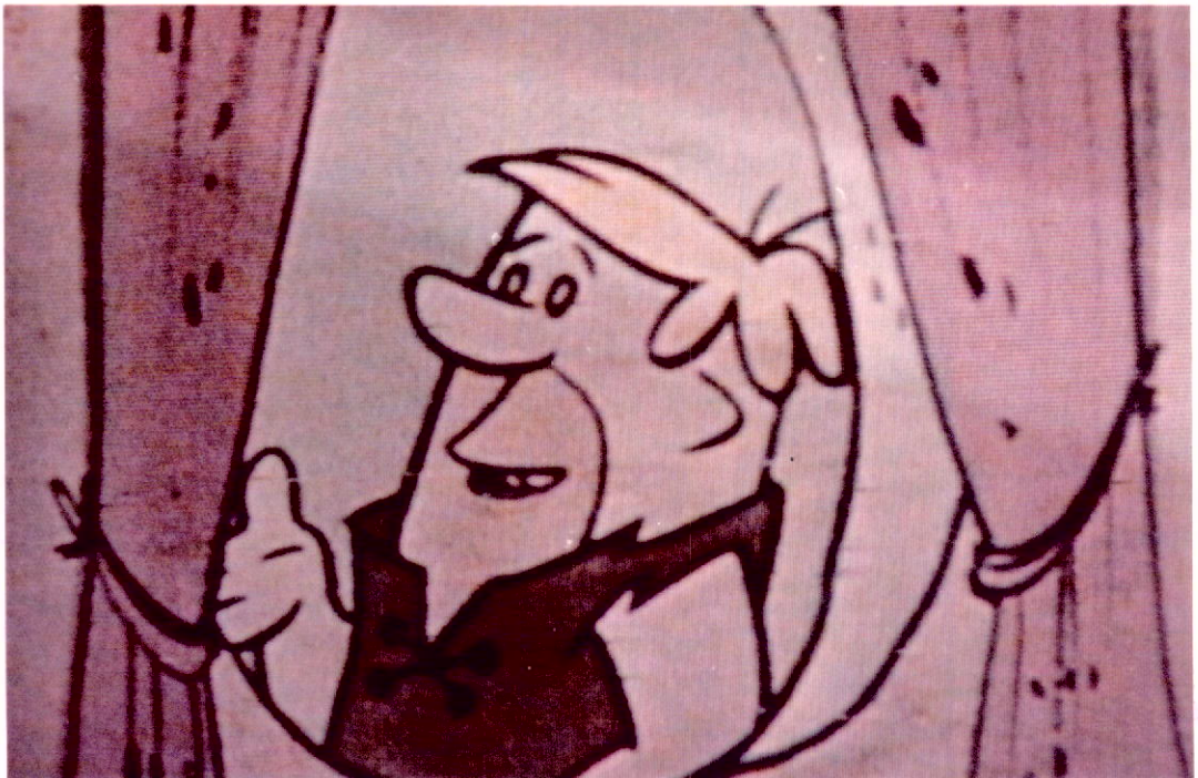
Fig. 7 - Imagem de TV obtida através do demodulador PLL, com a relação C/N de 6 dB.
