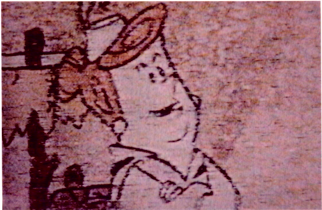
Fig. 13 - Imagem de TV obtida através do demodulador PLL, com a relação C/N de 0 dB.
