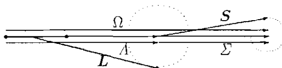
Fig. 2.1 - A precessão do momento angular orbital L e spin S sobre o eixo internuclear (considerado aqui, por simplicidade, fixo no espaço) de uma molécula diatômica.
