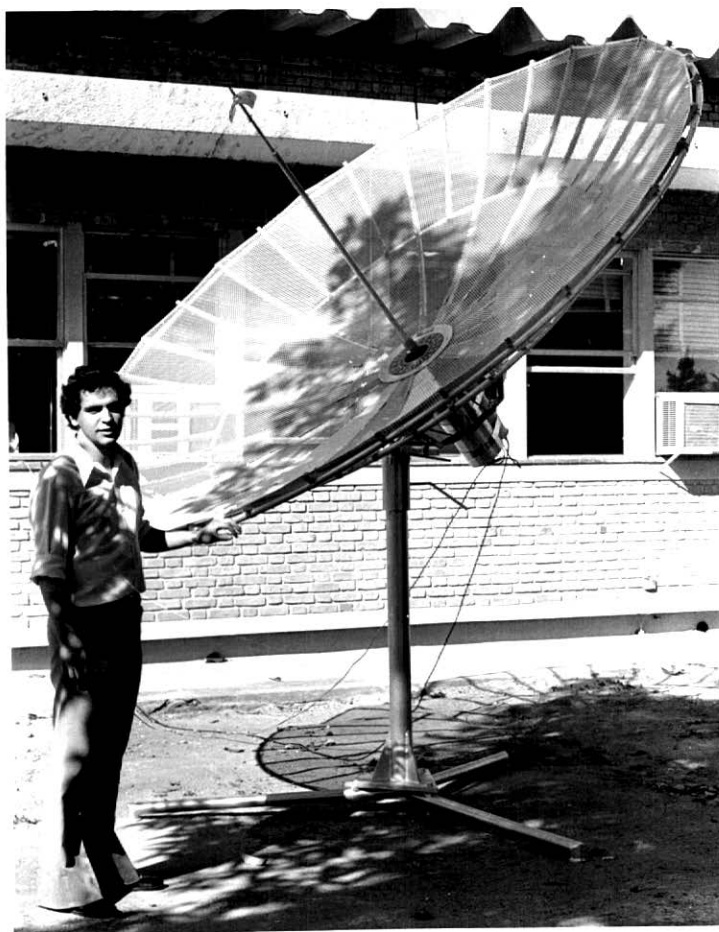
Fig. 5 - Estação receptora dos sinais WEFAX transmitidos pelo satélite meteorológico síncrono (SMS) em 1691 MHz, com antena, amplificador de baixo ruído e adaptador de sinal.
