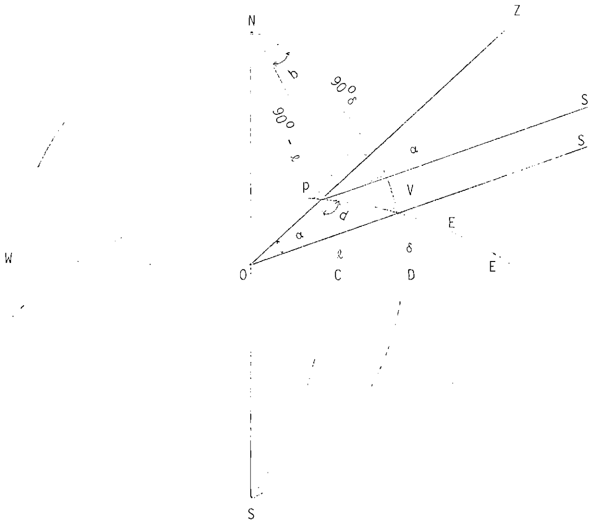
Fig. A.1 - Relação entre os ângulos: distância zenital ( \alpha ), a latitude ( \lambda ), a declinação ( \delta ), o ângulo horário ( b ), o azimute ( d ) e a altura ( E ), do Sol.
