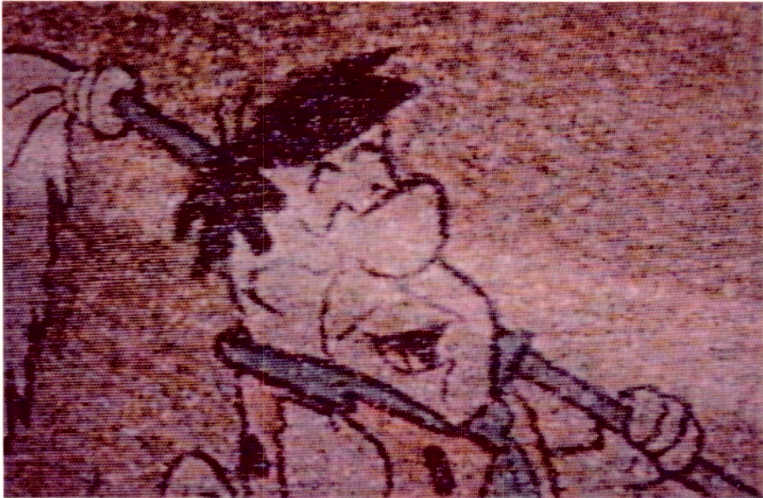
Fig. 20 - Imagem de TV obtida através de um demodulador sem extensão de limiar, com relação C/N de 3 dB.
