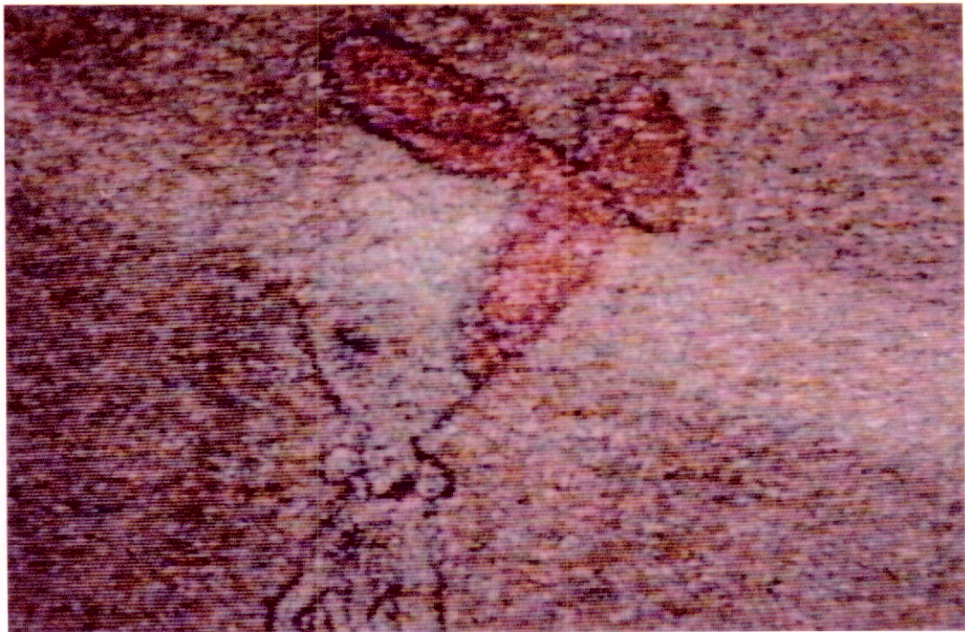
Fig. 21 - Imagem de TV obtida através de um demodulador sem extensão de limiar, com relação C/N de 2 dB.
