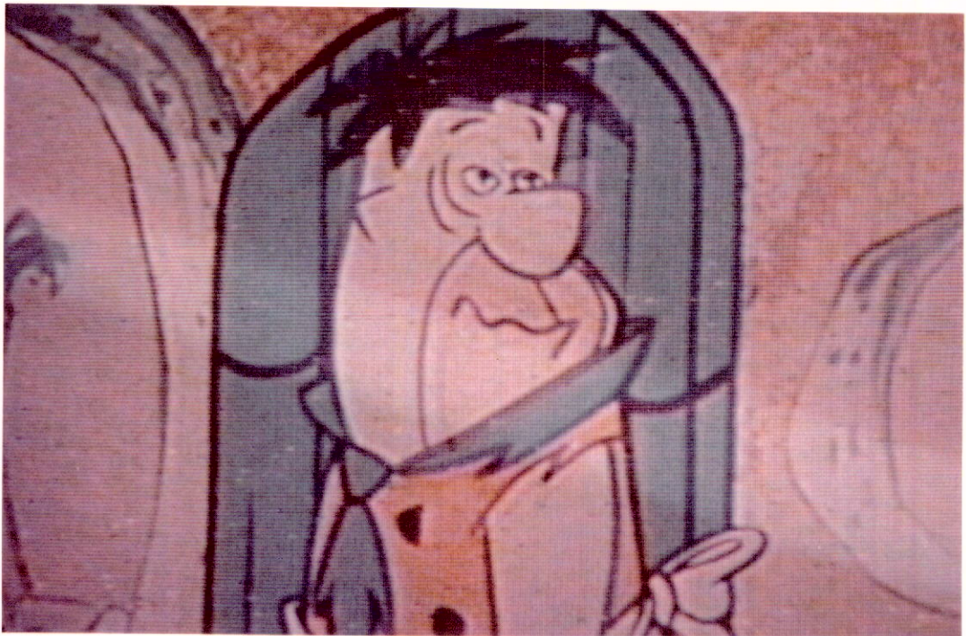
Fig. 15 - Imagem de TV obtida através de um demodulador sem extensão de limiar, com relação C/N de 8 dB.
