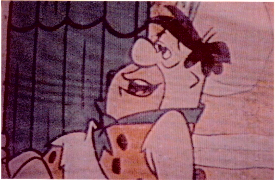
Fig. 14 - Imagem de TV obtida através de um demodulador sem extensão de limiar, com relação C/N de 9 dB.
