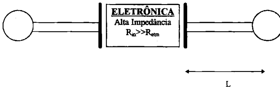
Fig. 3.3 - Esquema da Sonda Dupla. R_m é a impedância da eletrônica e R_{atm} é a impedância da atmosfera.
