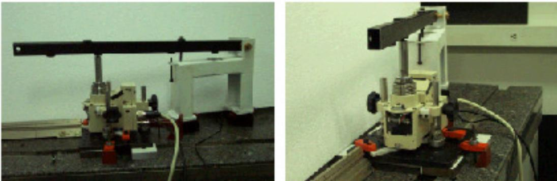
Figura 3-2: Sistema de indentação e interferômetro radial MTRES
